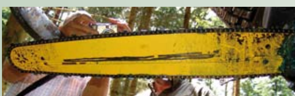
Abb. 7: Harvester mit speziellem Lochschwert zur Ausbringung der Sporensuspension
