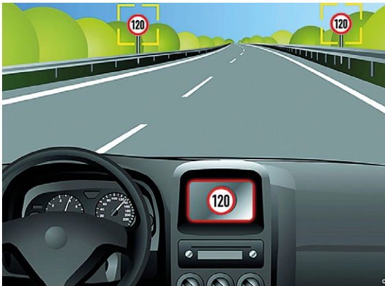
Schilderkennungssystem der Hella Aglaia Mobile Vision GmbH
