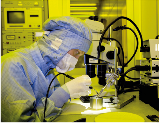
Montage von Laserstacks am Ferdinand-Braun-Institut
